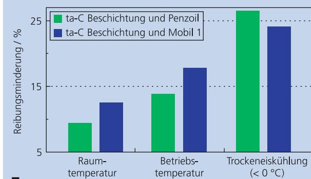
gemittelte Reibungsreduzierung bei verschiedenen Temperaturen. Im Ergebnis gewähren die Diamor®-Schichten in diesem Experiment einen Reibungsvorteil von 10 - 30 Prozent je nach Lauftemperatur.
